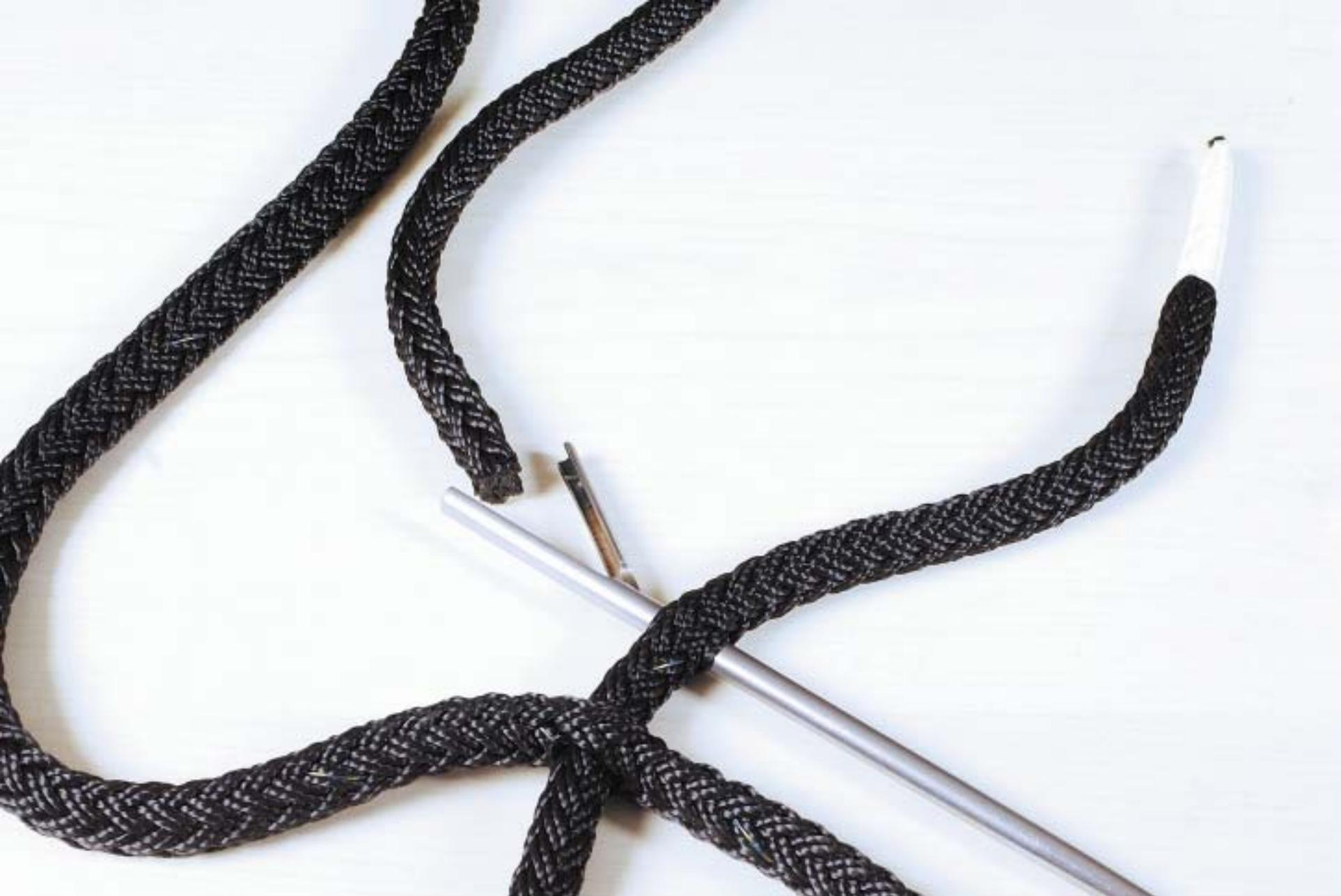
Faites passer l'autre extrémité du bout par la partie courte, et serrez.
