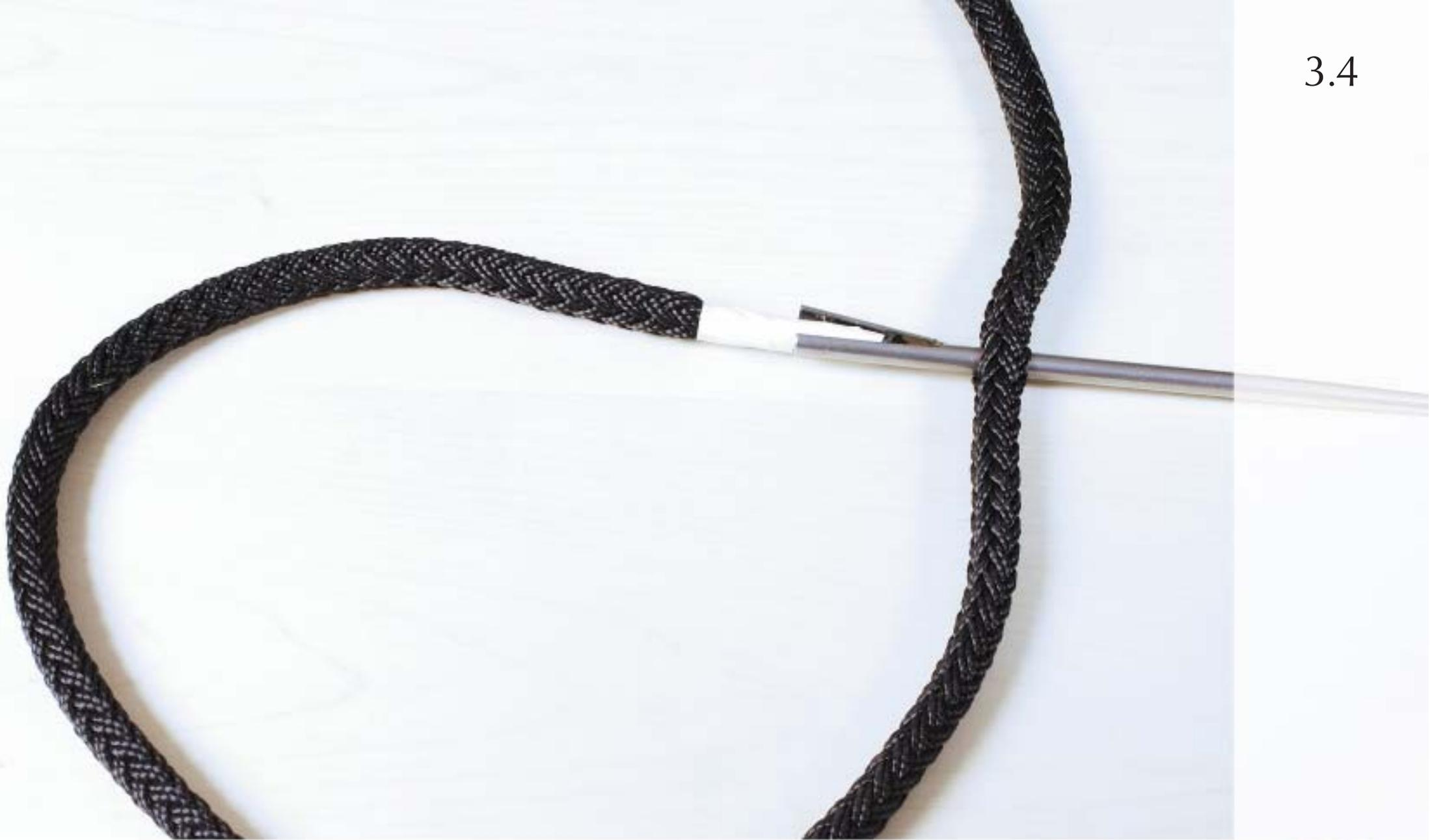
Calculez une longueur de  $40 \times$  le diamètre, + la longueur de l'œil, puis passez l'aiguille par ce point.
