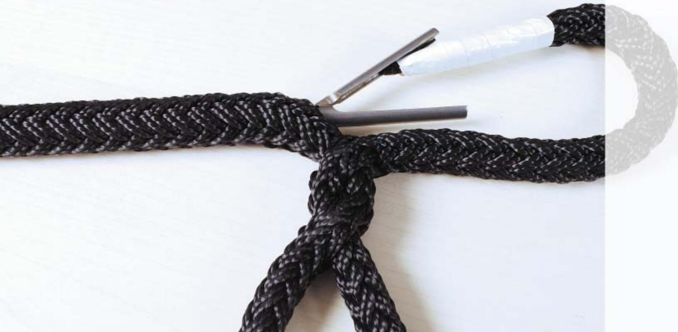
Coincez à nouveau l'extrémité la partie courte dans l'aiguille pour l'enfiler dans la tresse.
