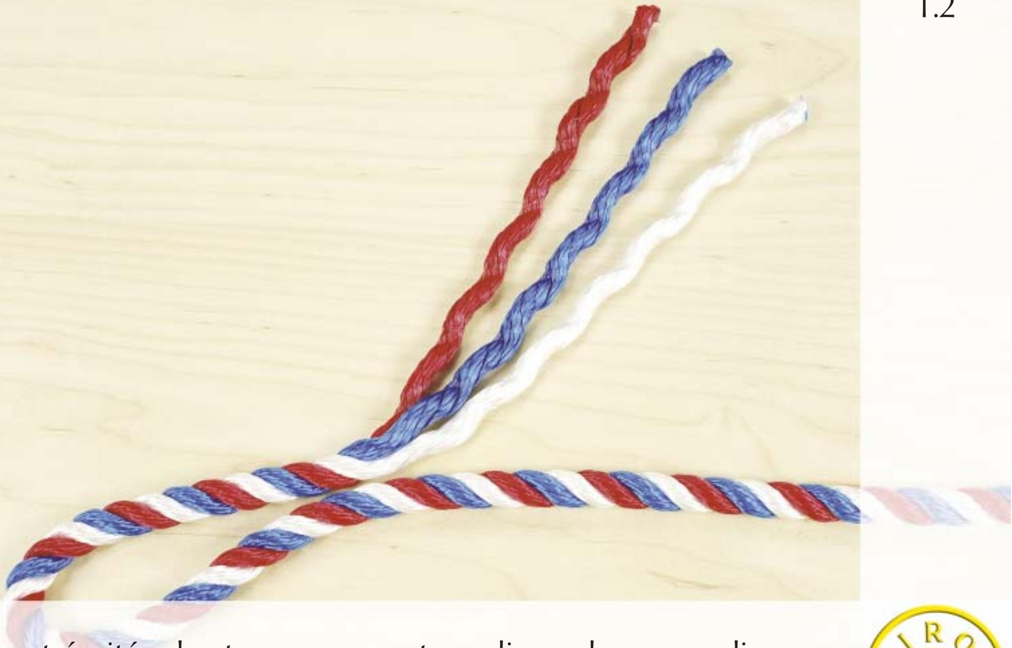
Si les extrémités des torons ne sont pas lisses, les «arrondir» avec le fer à couper, ou les couvrir avec un peu d'adhésif.
